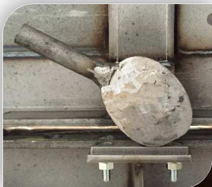
Came à excentrique (cémentée)
