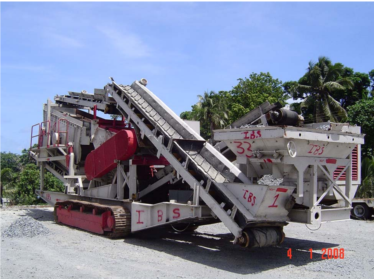
CONCASSEUR SECONDAIRE KLEEMANN MOBIFOX MF15D3E
